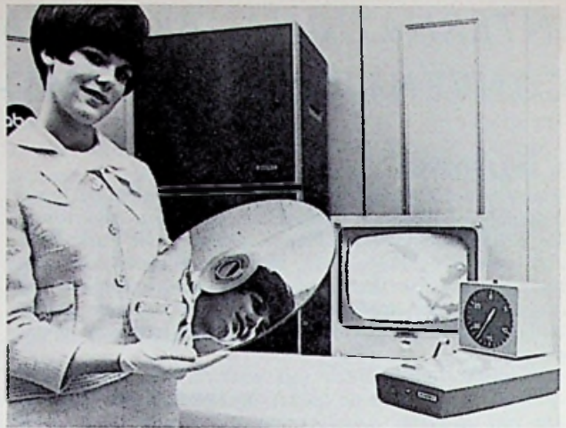
Afb. 1. Deze Amerikaanse jongedame houdt de gemetalliseerde, magnetische geheugenschijf in haar handen, die wordt toegepast in de Ampex HS100 kleuren-schijfmagnetoscoop.
