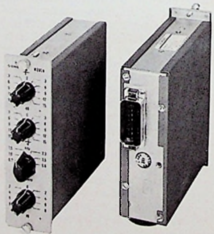
Afb. 7. Tooncorrectie- met presence- en absencefilter.
