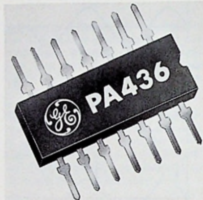
Afb. 3. Monolytische geïntegreerde schakeling voor fasehoekbesturing van triacs (General Electric)
