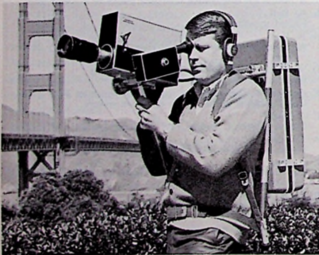
Afb. 2. Cameraman, regisseur en registratietechnicus zijn in één persoon verenigd bij gebruik van de Ampex VR3000, de draagbare magnetoscoop/cameracombinatie. De camera hierbij is type BC300 (achroom).
